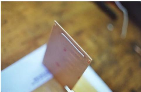
Brücken an die richtige Position lt. Plan einsetzen und Enden etwas umbiegen, so daß sie nicht mehr herausfallen können.
