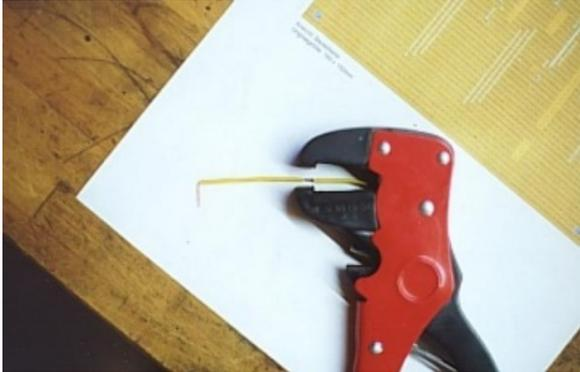
Ein Stück Draht ablängen (Lochrasterlänge + 1cm Überstand [li.] + 1cm Überstand [re.]) und Enden so abisolieren, daß der verbleibende isolierte Teil etwa (eher etwas kürzer) dem Lochabstand entspricht, für den die Brücke gedacht ist.
