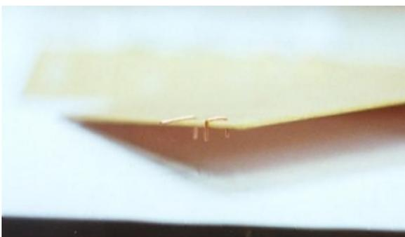
Die kleinen Brücken können auch über den Rand der Platine gebogen werden (dazu erst eine Seite mit der Spitzzange biegen, in das passende Loch stecken und dann mit dem Daumen um die Kante biegen)
