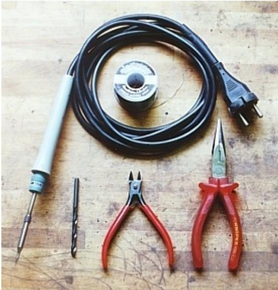
**Lötkolben** bekommt man vielerorts - allerdings sollte man auf eine brauchbare Spitze, sowie auf die Leistung (Watt) achten. Da wir keine Dachrinnen, sondern elektronische Bauteile löten möchten, empfiehlt sich ein recht schwaches Gerät (bis 30Watt) mit einer bleistiftspitzen Lötspitze.
